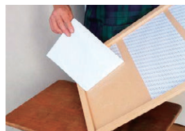
リサイクルデスク天板裏面の両面テープの剥離紙を剥がします。
